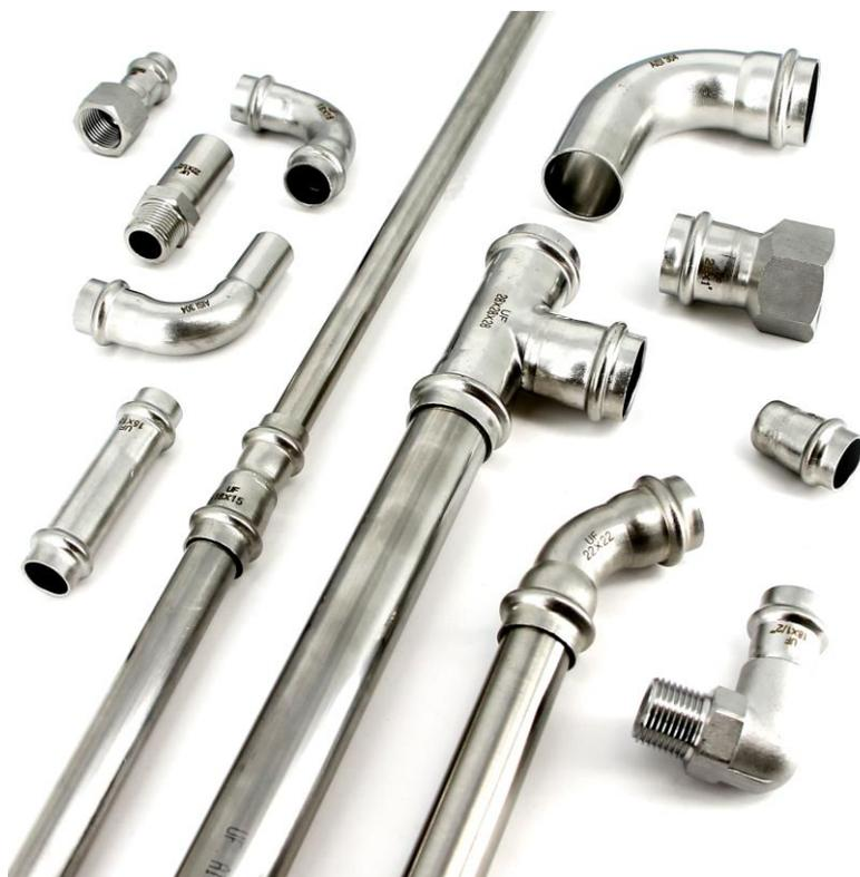
Ассортимент Uni-Fitt дополнился трубами и пресс фитингами из нержавеющей стали марки AISI 304. Рекомендованы к применению в системах отопления, горячего и холодного водоснабжения, транспортировки сжатого воздуха и технических газов при максимальном давлении и температуры 16 бар и 110 °С соответственно.
