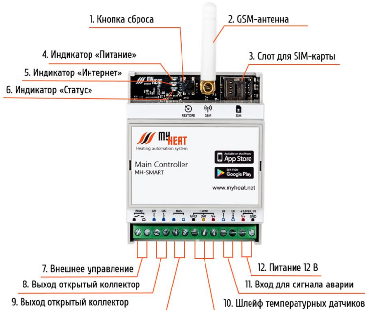
Рис.1. Внешний вид контроллера MY HEAT SMART
